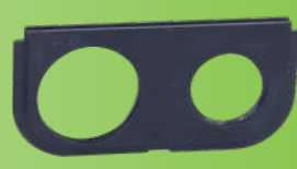
一个用于管道安装脚的 1" BSPP 孔和一个用于电缆接头 M25 x 1.5 的孔
